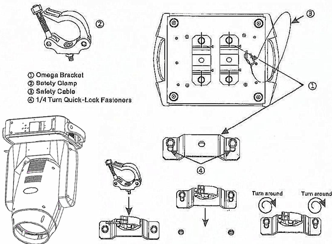
不管您选择哪种吊挂，请谨记务必使用安全绳。产品底部有配备专门的安全绳吊挂点，请参考上图，而且请谨记使用专门提供的安全绳吊挂点，千万不能将安全绳装于提手位置。
